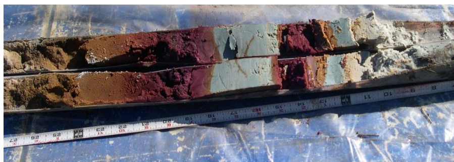
Carotte de sol provenant d'un site à Gainesville, en Floride, traité avec la technologie ISGS.
